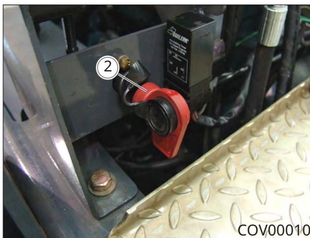
Obrázek 4.7. - Izolátor baterie - Poloha OFF
