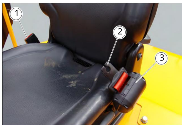
Obrázek 4.23 - Automaticky navíjecí se bezpečnostní pás
