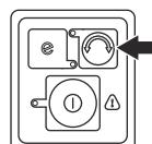
**Megjegyzés:** A forgásirány az óramutató járásával egyező irányra történő módosításával fellazulnak a fűvágó késre/fűvágó-fejre tapadt, levágott anyagok. Az óramutató járásával ellentétes irány visszaállása előtt a fűvágó kés/fűvágó-fej sebessége rövid időre lelassul.
