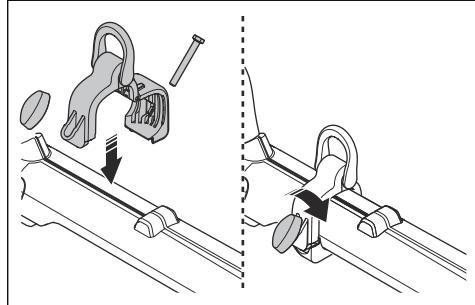
3. Podłączyć końcówki wieszaka w kształcie pętli.
