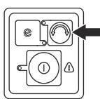
**Poznámka:** Keď sa smer zmení na otáčanie v smere hodinových ručičiek, skosený materiál sa uvoľní z noža na trávu/rezacieho zuba na trávu. Otáčky noža na trávu/rezacieho zuba na trávu sa na krátke čas znižia a potom sa znova začne otáčať proti smeru hodinových ručičiek.
