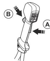
1. Sprawdzić, czy włącznik zasilania jest zablokowany, gdy blokada znajduje się w swoim położeniu wyjściowym.
