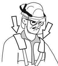
5. Seřídte nosný popruh tak, aby byl řezací nástavec rovnoběžný s povrchem terénu.
