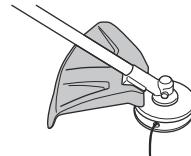
3. Poškozený kryt řezacího nástavce je nutné vyměnit.
