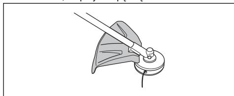
3. Wymienić osłonę osprzętu tnącego, jeśli jest uszkodzona.
