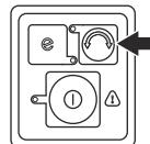
**Uwaga:** Jeśli kierunek obrotów jest zmieniany na obrot w prawo, ścieży materiał zostaje usunięty z tarczy tnącej/noża do trawy. Prędkość obrotowa tarczy tnącej/noża do
